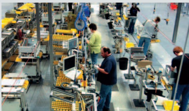
La línea de fabricación de las calderas murales a gas
